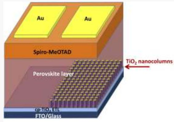
*Nanostructures: e.g. TiO<sub>2</sub> nanocolumns*
